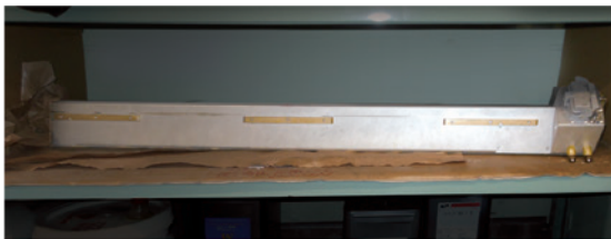
用途に応じて任意の胴間に取り付けられるインターデッキUV乾燥装置
