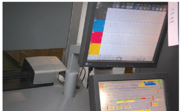
オペレーションスタンドにある自動カラー測定システムで安定した色環境を実現
